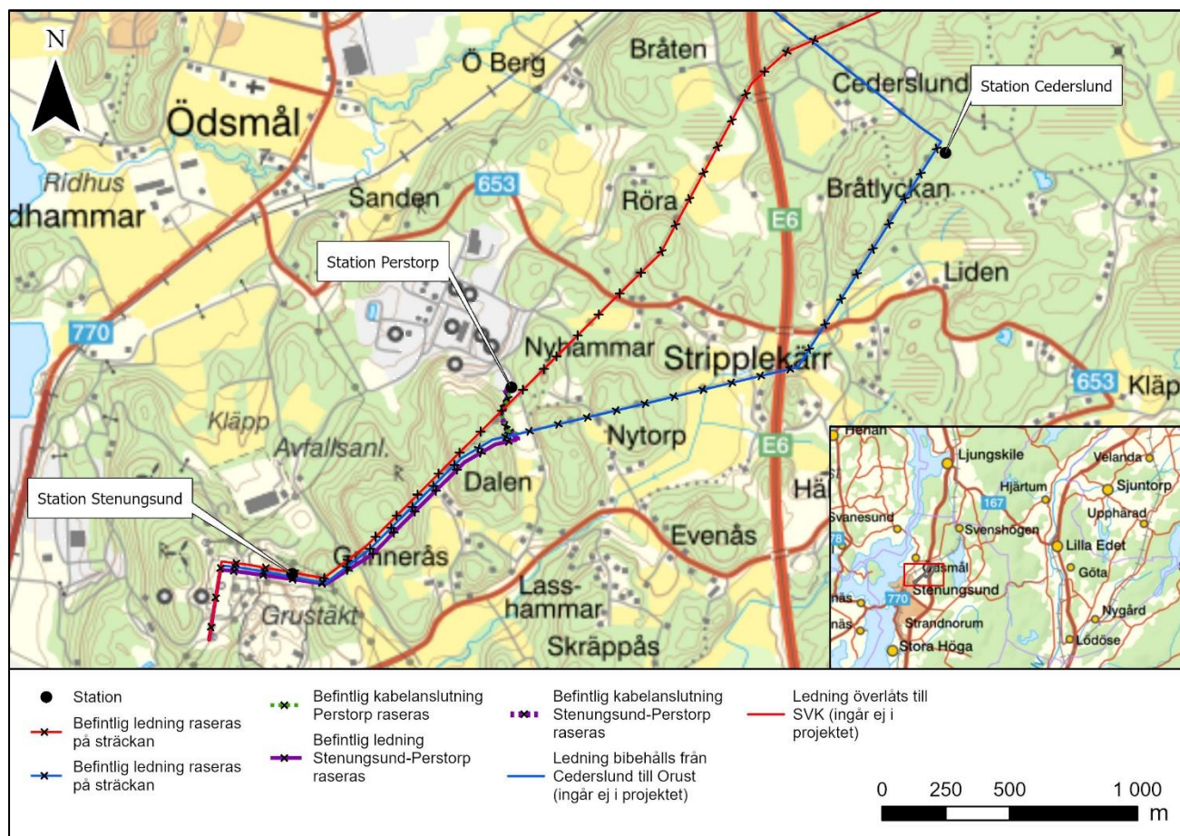
Figur 4. Planerade åtgärder på befintliga ledningar, sträckor som planeras raseras respektive bibehållas eller överläts.
