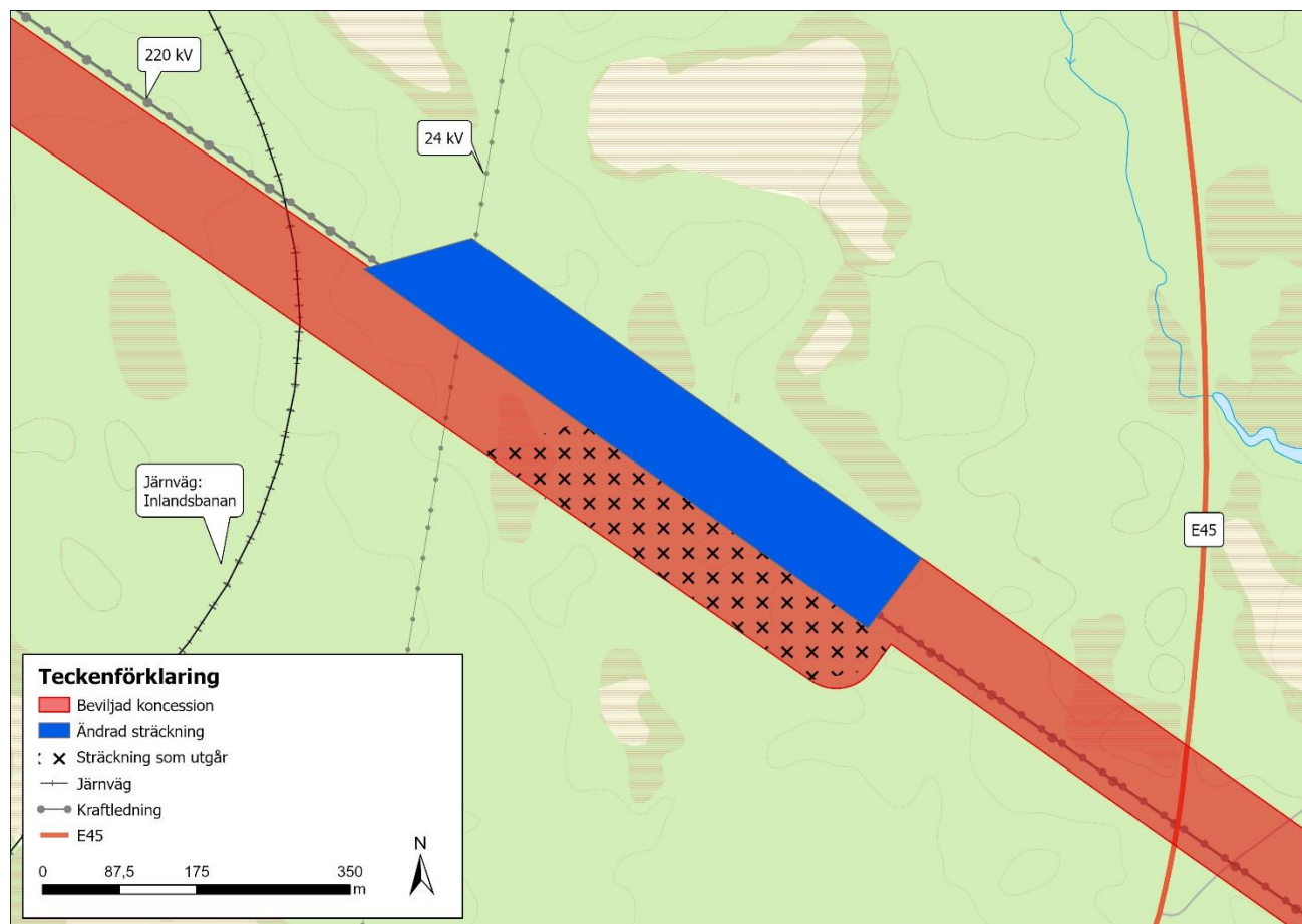
Figur 2. Kartan visar nu aktuell ändring (blått) där sträckningen fortsätter norr om befintlig 220 kV-ledning ytterligare 500 meter (markerat med blått) jämfört med beviljad koncession. Ändringen innebär att sträckning markerad med kryss utgår.
