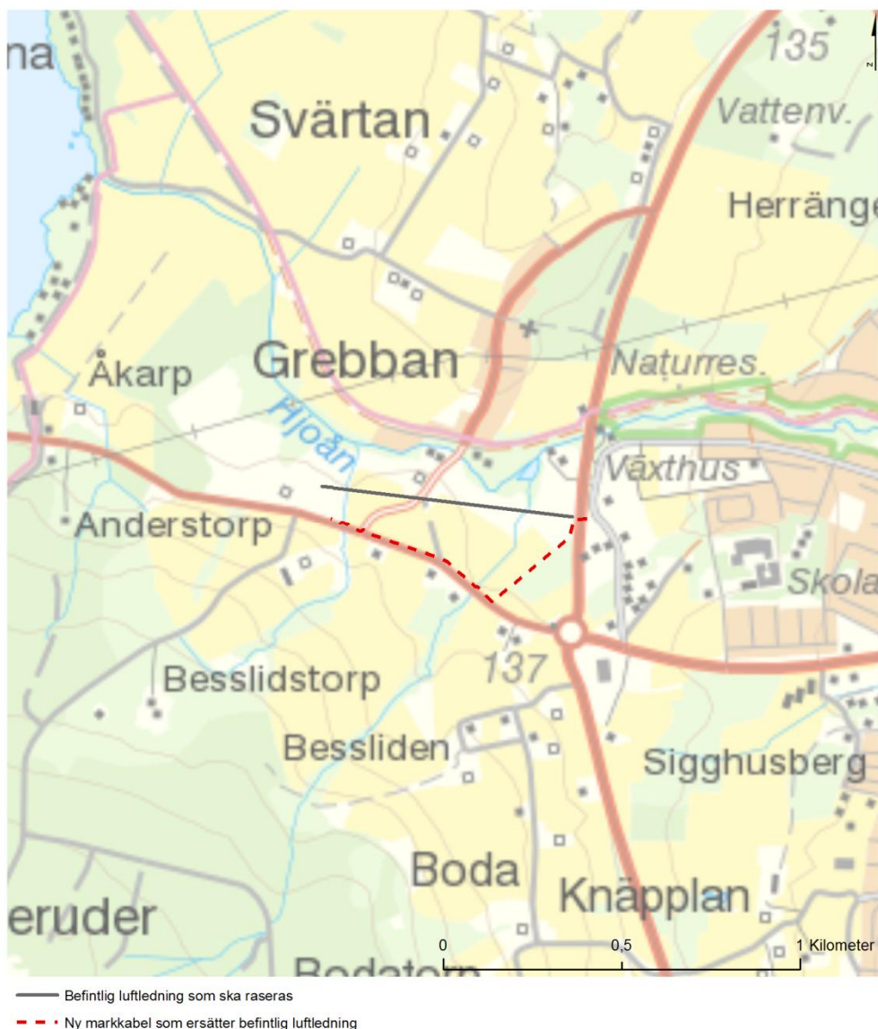
Figur 3. Planerad markkabel (röd streckad linje) och den befintliga luftledningen (grå heldragen linje).
