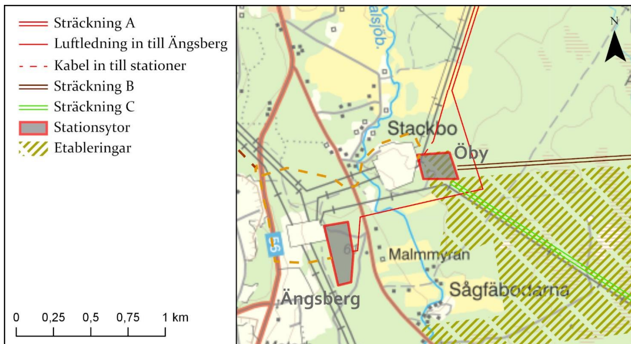
Figur 7. Stationsområdet och hur ledningarna är tänkta att ansluta till Stackbo och Ängsberg
