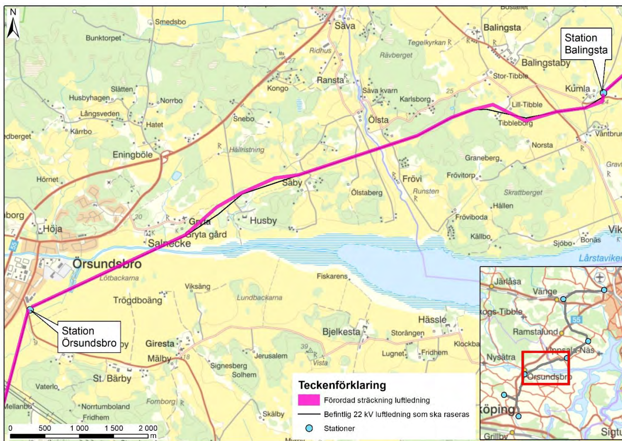
Figur 7. Förordad sträckning mellan Balingsta-Örsundsbro. Ledningen byggs med markkabel (minst 50 m) i anslutning till stationen.
