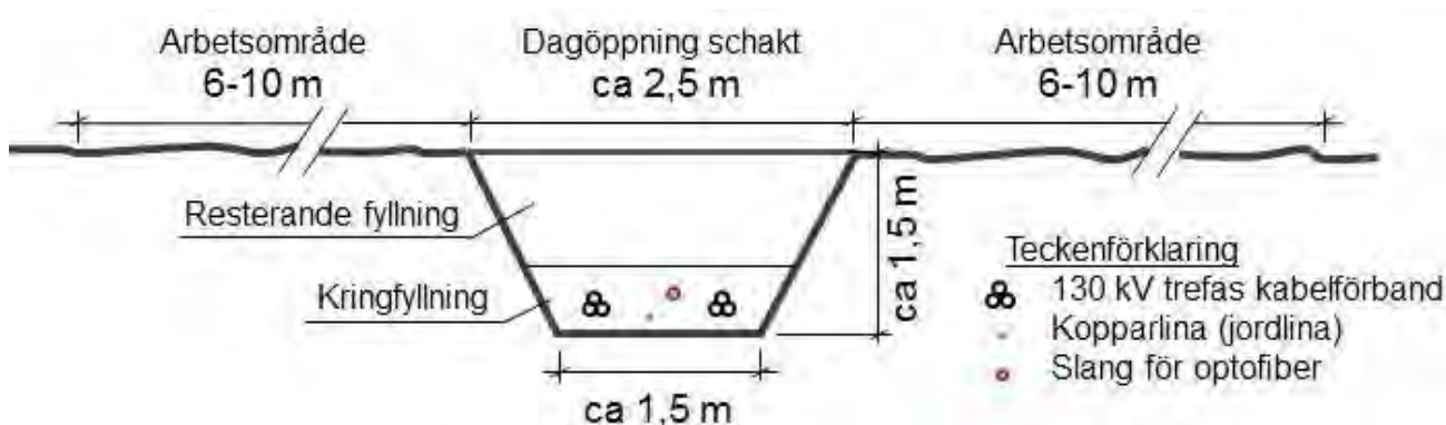
Figur 7. Principskiss på genomskärning av kabelgrav.
