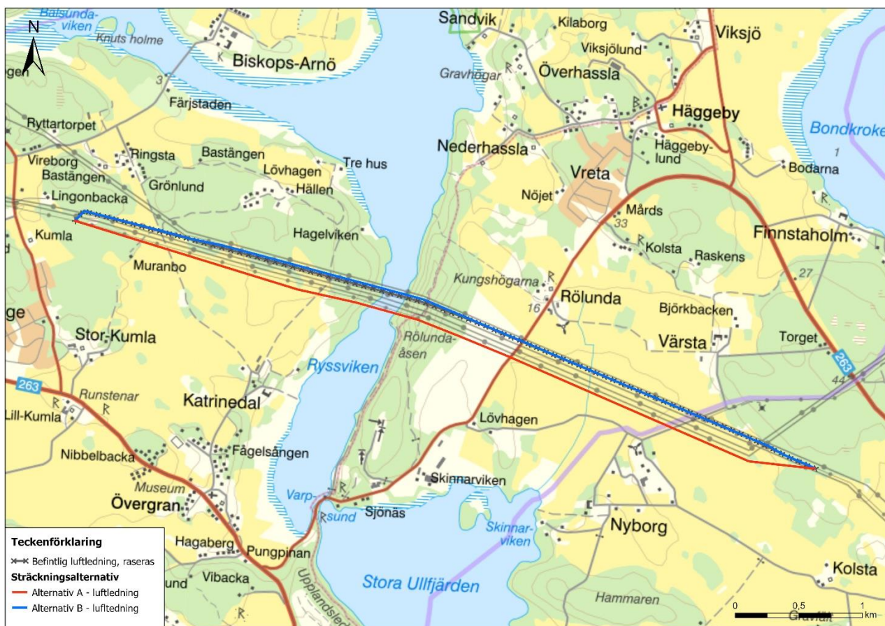
Figur 3. Karta över föreslagna sträckningar för planerad kraftledning inom utredningsområdet. Kartan återfinns i större format i Bilaga S1.
